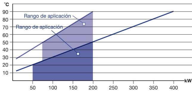
— = Intercambiador de calor de casco y tubo de 50°C – 90°C
